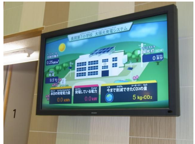
太陽光発電表示装置（1階多目的スペース）
