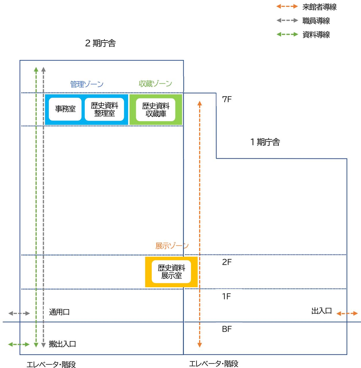
※新庁舎歴史資料展示室を設けることとなった市役所本庁舎は、災害発生時に災害対策本部の機能を十分に発揮することを基本的な考え方としています。大地震発生時においても補修することなく継続使用できるよう、「官庁施設の総合耐震計画基準」(国土交通省大臣官房官庁官署部)による耐震安全性能の分類で、構造体はI類、建築非構造部材はA類、建築設備は甲類を適用し、免震構造を採用しています。免震構造は、耐震構造の地下1階駐車場の柱頭部を、ゴム・ダンパーによる免震層とした中間免震とするもので、建物に搖れが伝わりにくいため建物や設備類の補修を要せず、家具や設備類が転倒・落下する可能性も低い耐震安全性を目指しています。
